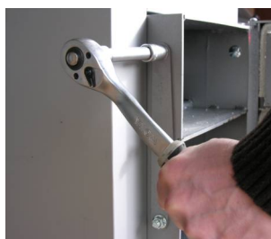
Fot.4. Odkręcić rygiel zamka
