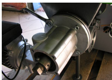
Fot.2. Odkręcić cztery nakrętki mocujące motoreduktor.
