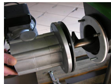
Fot.3. Wyjąć ślimak podajnika wraz z paliwem i oczyścić rurę z ciał obcych.
