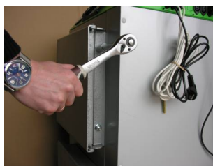
Fot.7. Zdemontować drzwiczki z włazu.
