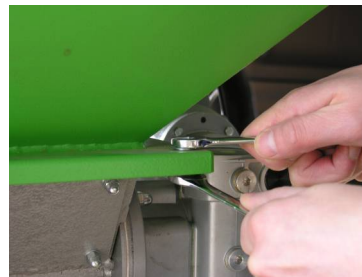
Fot.3. Dokręcić śruby mocujące zbiornik.
