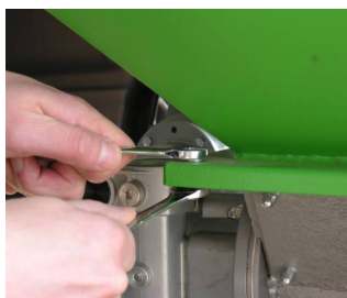
Fot.1. Odkręcić 4 śruby mocujące zbiornik paliwa.
