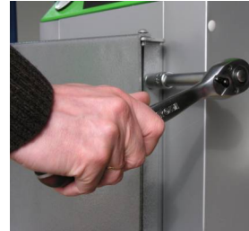
Fot.9. Regulacja drzwiczek (poluzować śruby, ustawić drzwiczki, dokręcić śruby).
