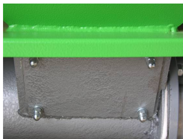
Fot.1. Odkręcić pokrywę otworu rewizyjnego i opróżnić zbiornik z paliwa.
